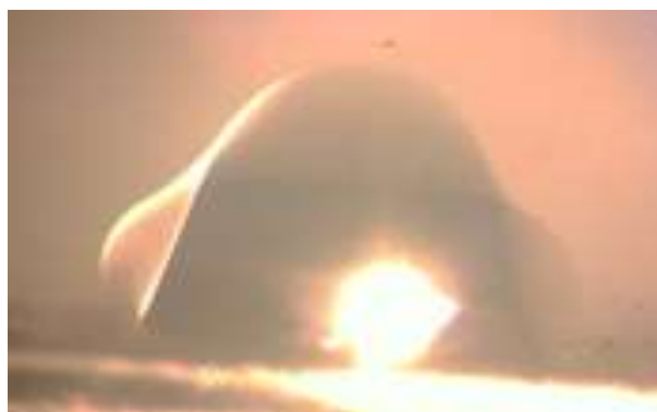
Рис. 3. Капиллярные колебания микрокапли воды, соответствующие квадрупольной моде релейевских колебаний (частота колебаний 220 Гц).
