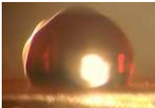
Рис. 6. Капиллярные колебания микрокапли воды с фиксированной границей типа стоячих волн. Огранка капли соответствует пяти стоячим волнам на профиле капли ( n=10 в формуле (4)).
