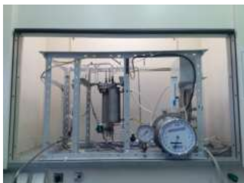
Рис. 5. Экспериментальная установка для гидротермального сжижения микроводорослей и продукты, полученные после НТЛ из МКВ (бионефть, водный раствор и твердый остаток)
